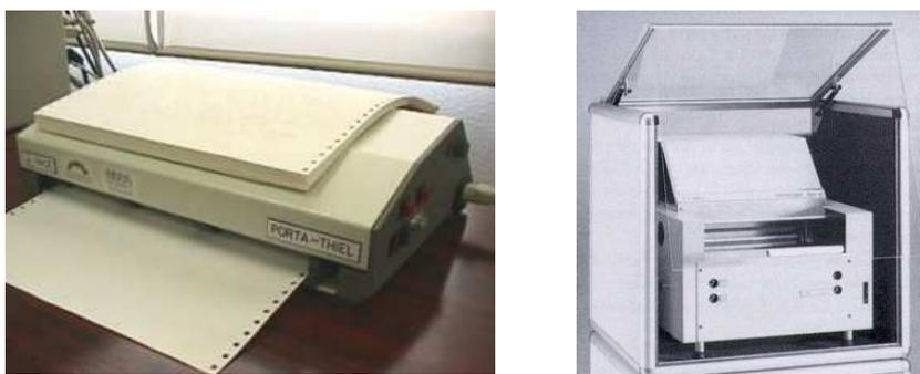
Figura 5.9 Impresora Braille Porta-Thiel en versión sobremesa e industrial (<http://acceso.uv.es/ayteca>)
