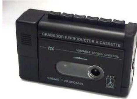
Figura 5.6. Magnetofon adaptado por la UTT para conseguir multiplicar por cuatro la duración de una cinta. (<http://acceso.uv.es/ayteca>).
