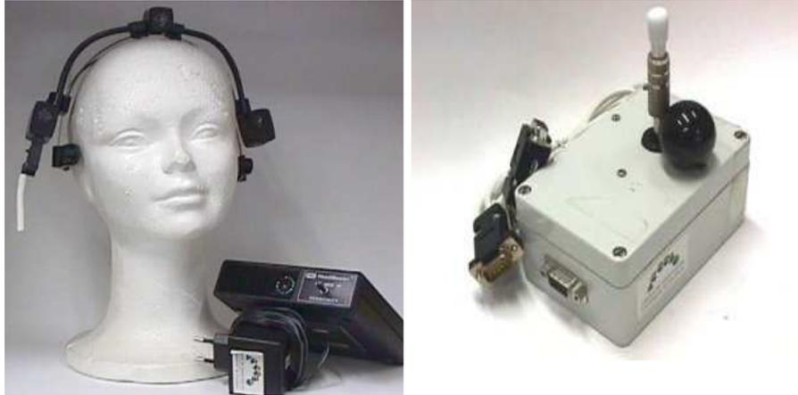
Figura 5.20. Headmaster (Izquierda) y emulador de ratón por joystick (derecha). Tomado de la Base de datos Ayteca (<http://acceso.uv.es>)
