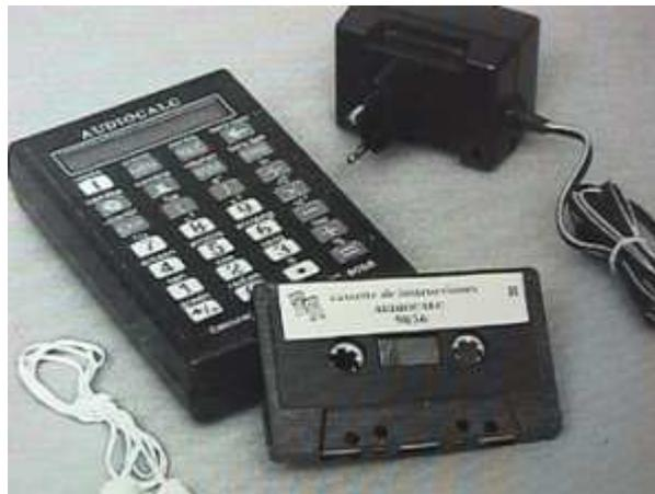
Figura 5.7. Calculadora con teclas con signos braille y respuesta por voz (<http://acceso.uv.es/ayteca>).
