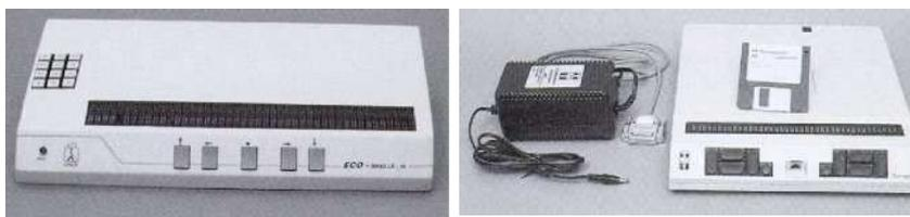
Figura 5.4. Líneas Braille de 80 y 40 celdas (<http://acceso.uv.es/ayteca>)
