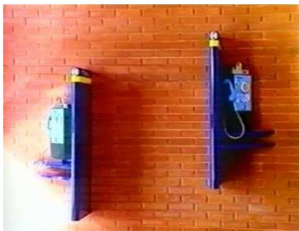
Figura 5.16. La presencia de usuarios de sillas de ruedas nos obliga a plantear un diseño de los espacios y mobiliarios de los campus universitarios que atiendan esta condición. En la fotografía se puede observar teléfonos públicos a diferentes alturas (Campus dels Taronges, UVEG)
