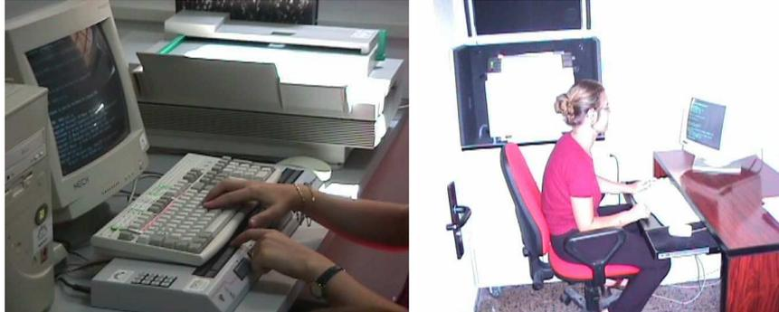
Figura 6.7. Obsérvese, el puesto de trabajo adaptado para personas ciegas del aula informática adaptada de la Asesoría Universitaria de Estudiantes con Discapacidad. En la fotografía de la derecha, uno de los técnicos transcribe a Braille un examen.
